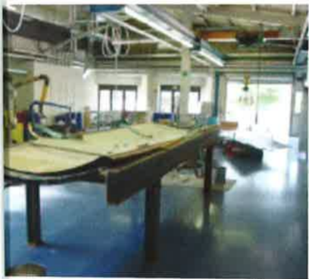
11 Modell des Moduls für Füllversuche © Intelligent Engineering Ltd.
