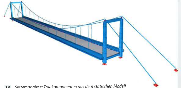
16 Systemanalyse: Tragkomponenten aus dem statischen Modell © Eiffel Deutschland Stahltechnologie GmbH
