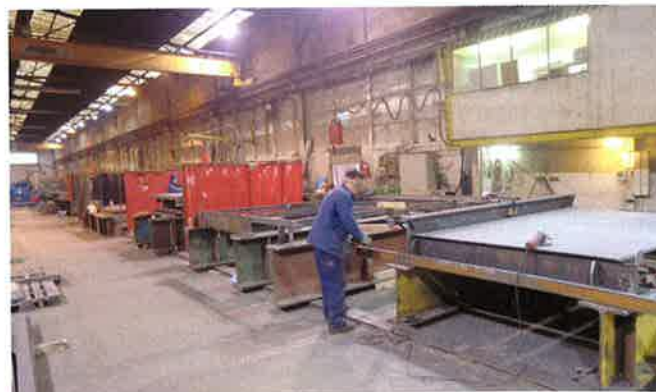
18 Serienfertigung von Fahrbahntafeln © Eiffel Deutschland Stahltechnologie GmbH
