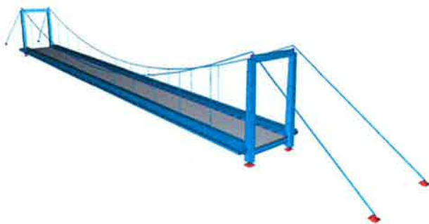
Bild 17 Systemanalyse (Tragkomponenten aus dem statischen Modell)
