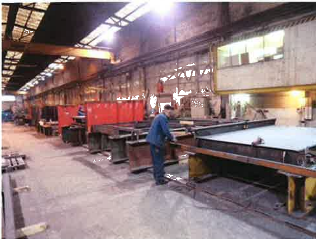
Bild 19. Serienfertigung von Fahrbahnplatten
