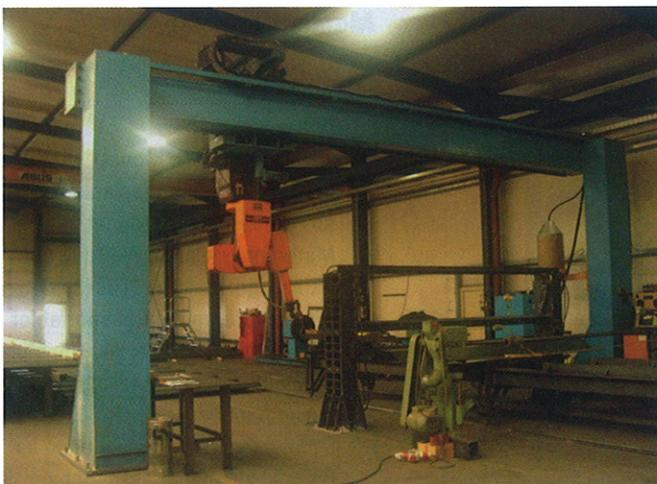
**Roboterportal zur Trapezstegfertigung**
