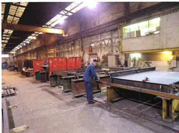
Bild 19: Serienfertigung von Fahrbahntafeln
