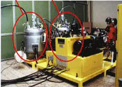
Bild 11: PUR-Mischanlage
