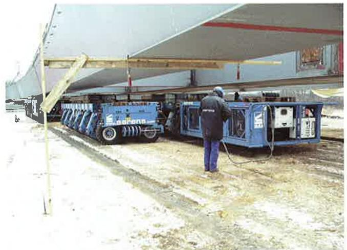
Bild 13. Unterbauten der Plattformwagen
