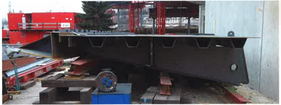
9 10 Gehweg im Normalbereich aus Gesimskasten mit Fahrbahn und Zweitbauteil im Werk und nach Vormontage © SEH Engineering GmbH
