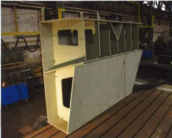
5 Querschnittsentwicklung: 1:1-Holzmodell zur Visualisierung © SEH Engineering GmbH
