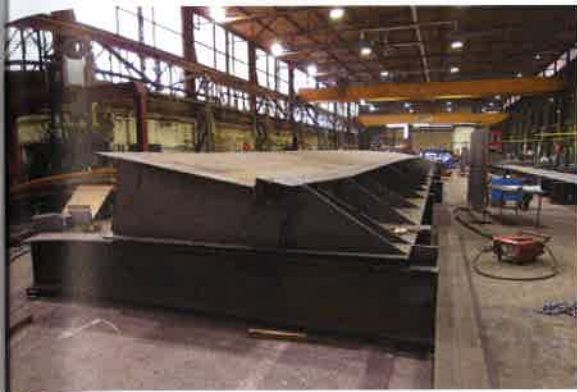
9 10 Gehweg im Normalbereich aus Gesimskasten mit Fahrbahn und Zweitbauteil im Werk und nach Vormontage © SEH Engineering GmbH
