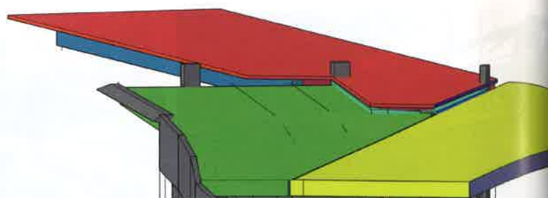
13 Montagebereich aus drei Ebenen: Rampe neu (grün), Rampe Bestand (gelb), temporäre Ebene (rot) © SEH Engineering GmbH
