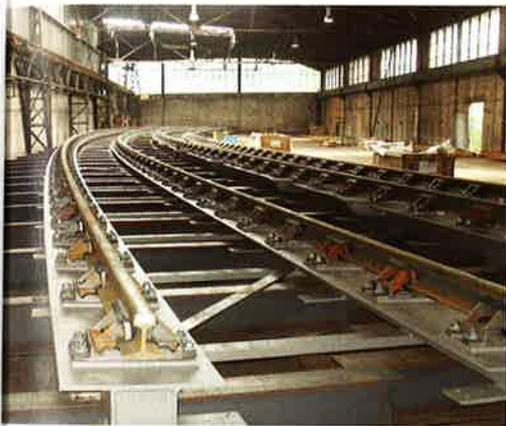
11 Feste Fahrbahn aus Schienenträger, Lager und Schiene
