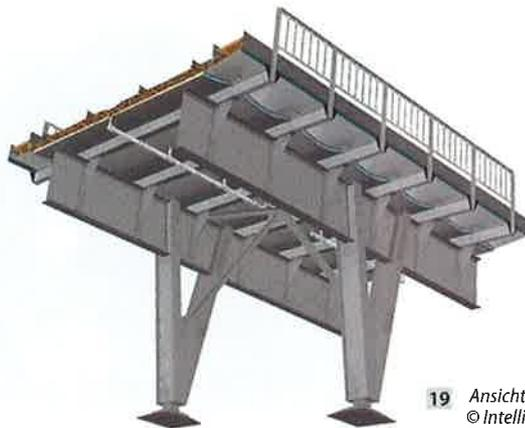
19 Ansicht eines SPS-verstärkten Brückenabschnitts
