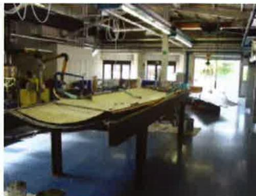
18 Modell des Sandwichmoduls für Füllversuche
