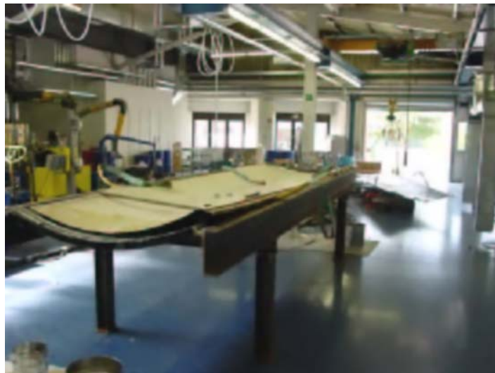
Bild 11. Modell des Sandwichmoduls für Füllversuche Fig. 11. Mock-up of sandwich module for injection tests
