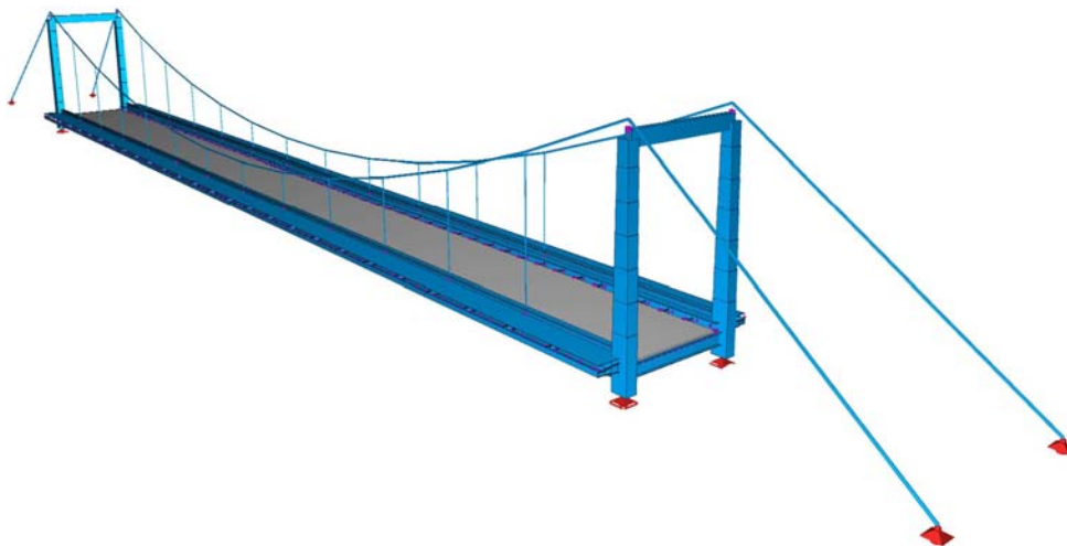
Bild 16 Computermodell der Hängebrücke Mettlach Fig. 16. Computer model of suspension bridge Mettlach
