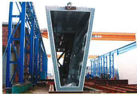
Vormontage im Versandbereich © Eiffel Deutschland Stahltechnologie GmbH
