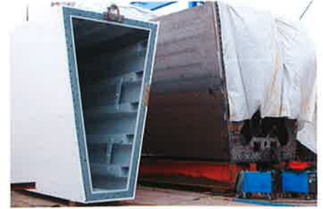
Element 1 vom einteiligen Bogen mit Fundamentanschluss © Eiffel Deutschland Stahltechnologie GmbH
